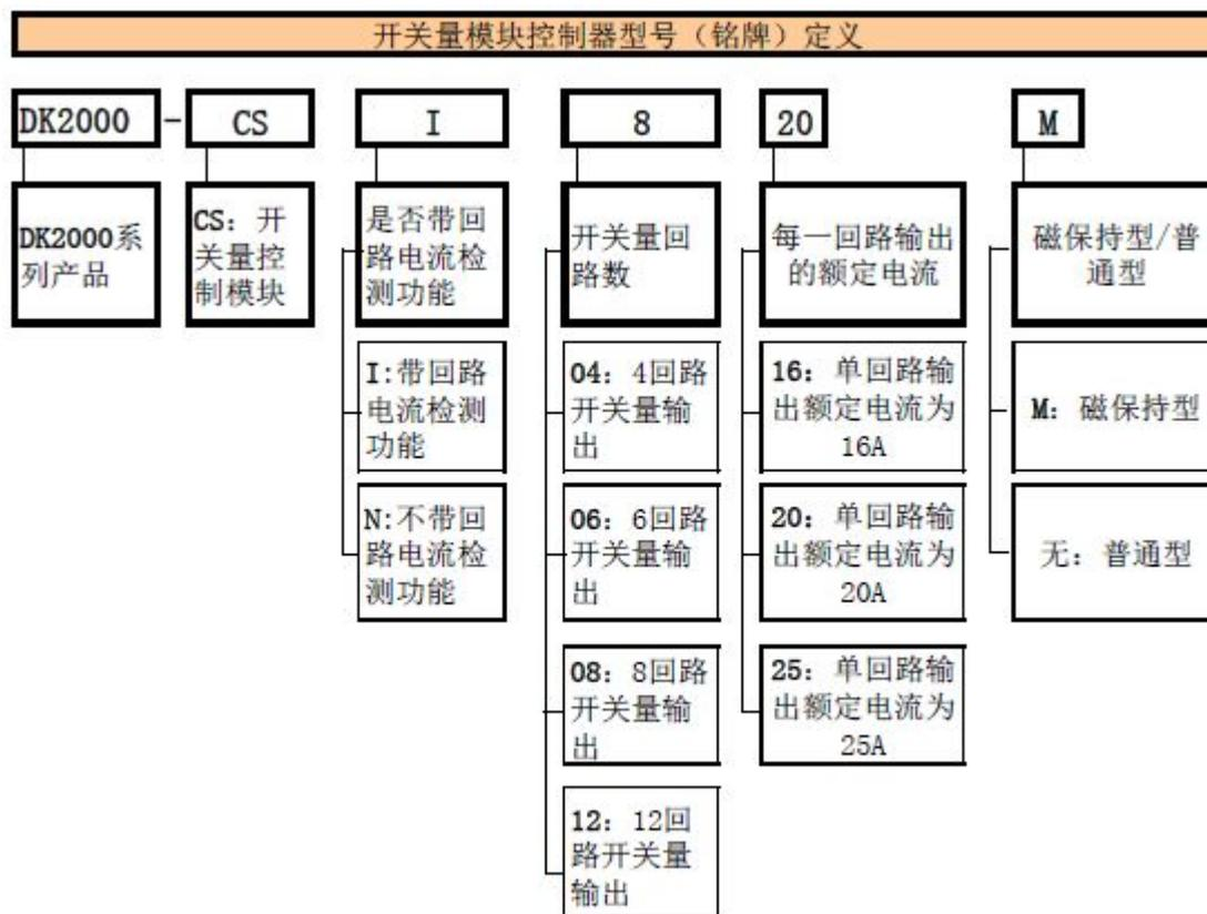
**注：6路和12路开关量控制模块无电流检测功能！**
