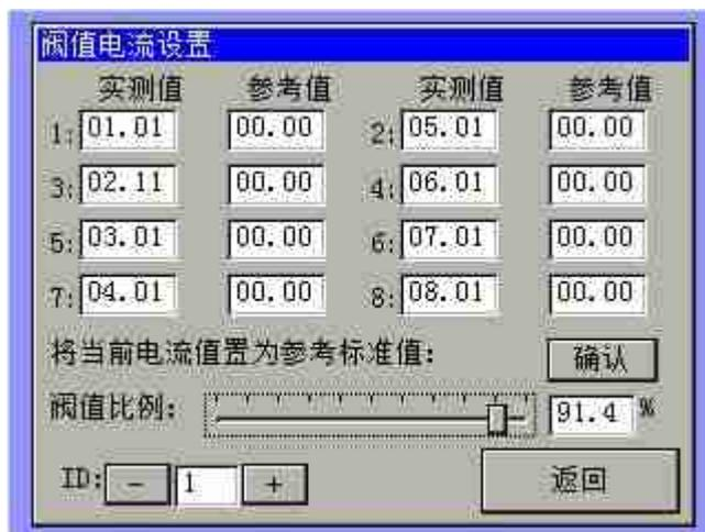
该设定功能是为了侦测回路中的负载是否有损坏（如果灯泡），当检测到的电流小于参考电流的阈值百分比时，相应回路会报警，提醒工作人员注意，应当检查线路并处理。可以在各回路状态电流正常的情况下，置当前电流为参考电流。电流阈值百分比用户可根据负载的性质，重要性等来评估设定。
